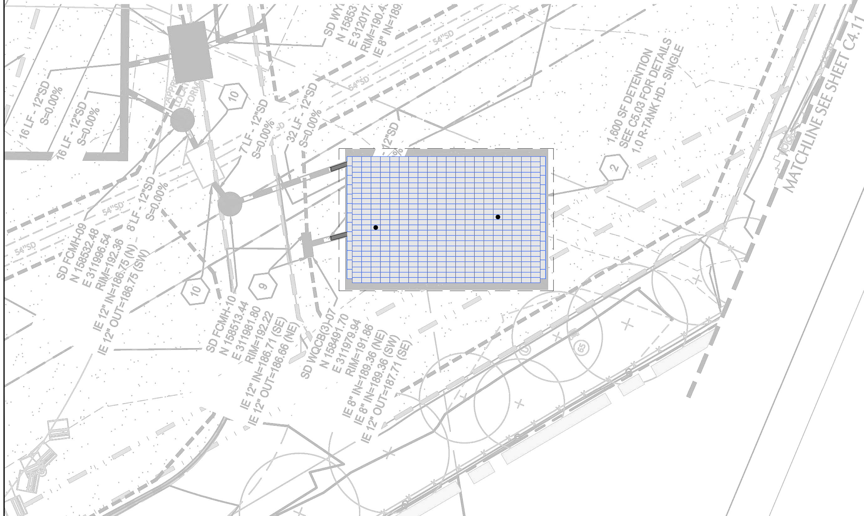
R-TANK HD SYSTEM OVERLAY SCALE: 1" = 15'
